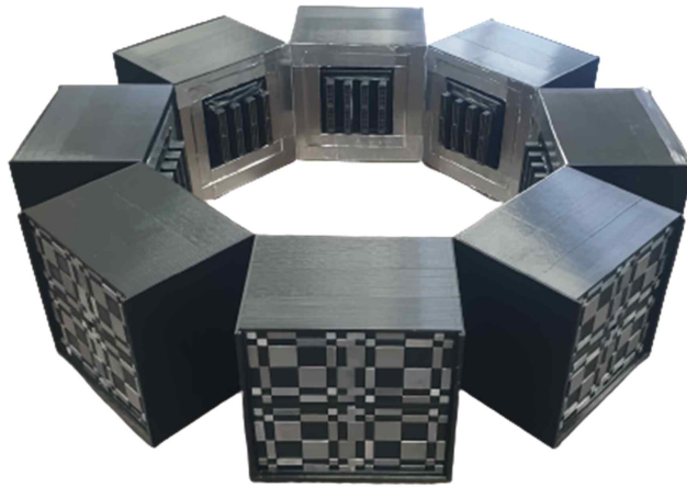
그림 11. 8개의 마스크를 사용한 링 배치 구조
