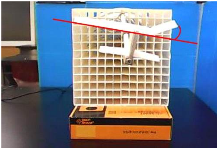
[그림 III-17] 시위선에 각도를 주었을 때 롤 평형 상태 변화.
