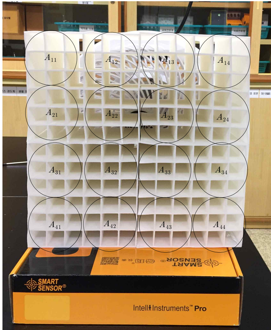
[그림 III-6] 풍속 측정 영역 분할.
