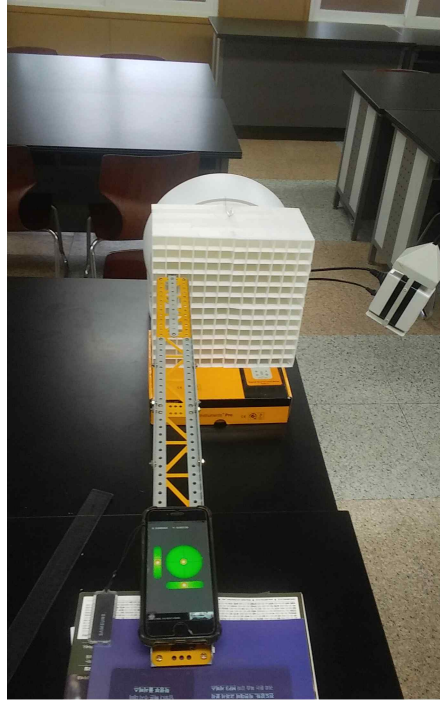
[그림 III-7] 풍속 측정을 위한 거치대 및 아이폰 수준기.
