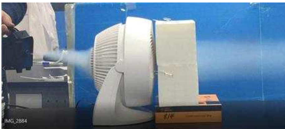
[그림 III-5] 연무기를 이용한 풍동 바람 유동 가시화.
