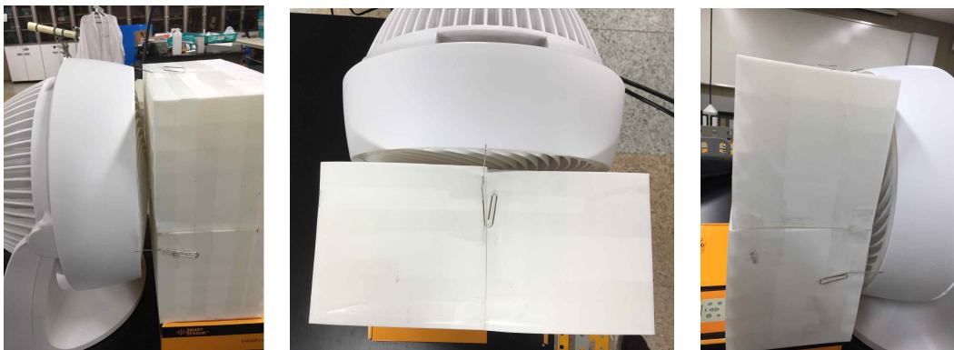
[그림 III-8] 에어컨쿨레이터 위치 고정을 위한 클립과 표시.
