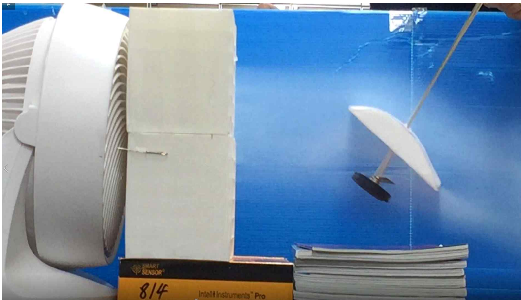
[그림 IV-12] 유선형 날개 주위의 유동. 날개가 상승하기 직전.
