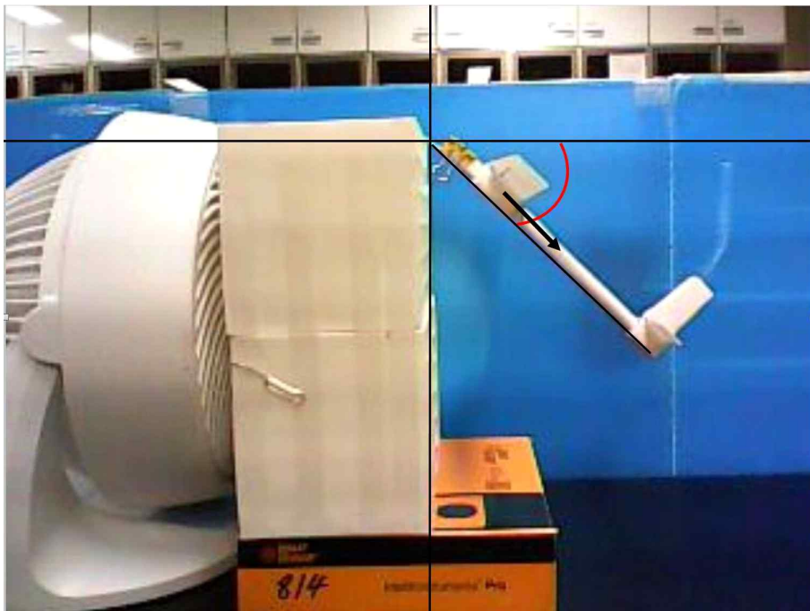
[그림 III-15] 주날개의 앞뒤 위치에 따른 피치 각도 변화 실험.
