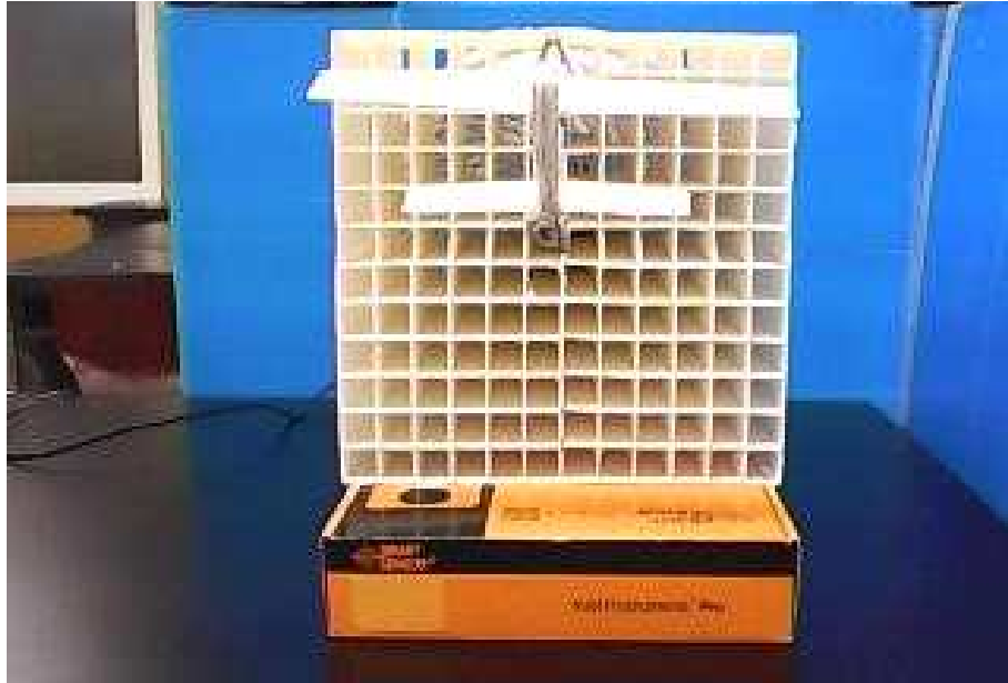
[그림 III-16] 시위선을 접지 않았을 때의 롤 평형 상태.
