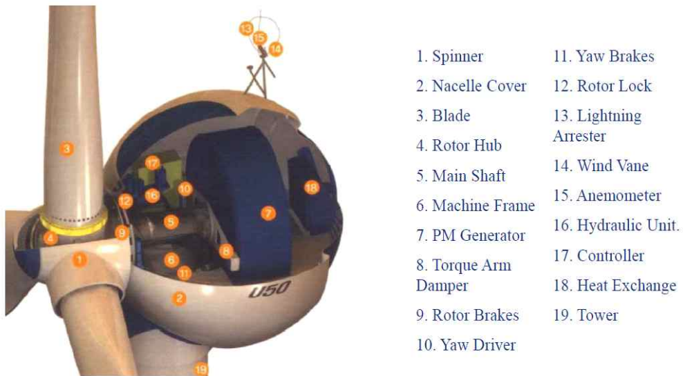
그림 8. 직접 구동 타입 풍력발전기 구조
