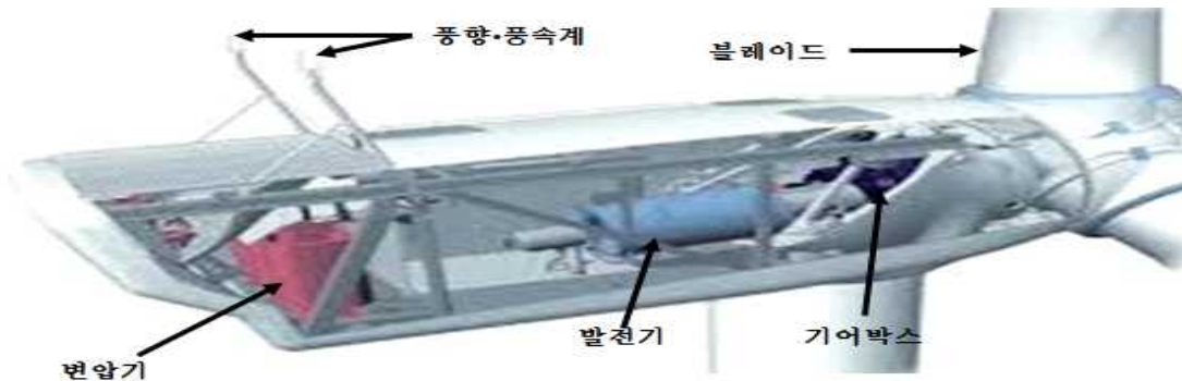
그림 2. 증속기 타입 풍력발전기 내부 구조
