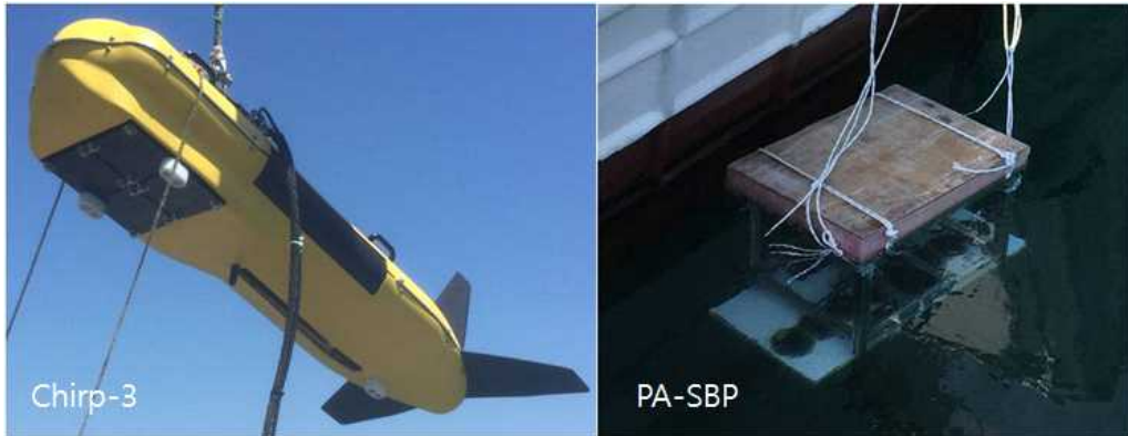
그림 4-52 일반적인 해저지층탐사기(Chirp-3) 외형 및 파라메트릭 배열기반 해저지층탐사기의 실험 치구
