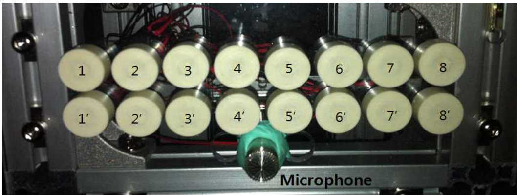
그림 4-6 공기중 지층탐사를 위한 송신 센서 배열과 수신 센서
