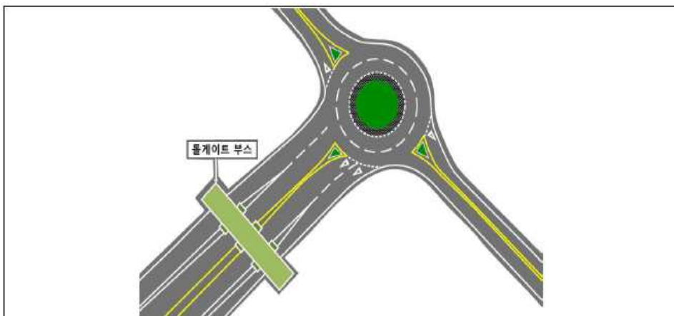
[그림 3-7] 고속도로 톨게이트 진·출입로 설치 예
