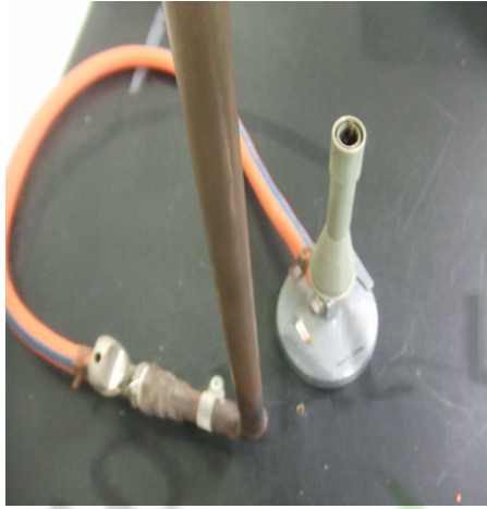
그림 3. 미세 유리관 끝을 부드럽게 하기 위한 가스 버너 장치
