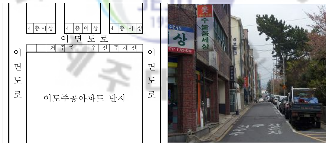
<그림 3-13> 제주시 이도주공아파트 주변 특수소방차량 진입 활용 곤란지역
