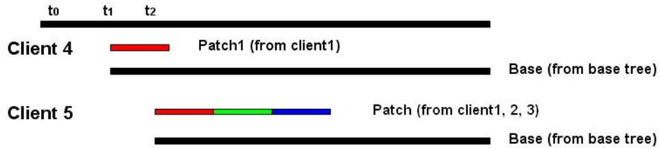
그림 11 기존에 서비스 받고 있는 Client4 와 새로 조인한 Client 5의 스트림 데이터 수신율 비교
