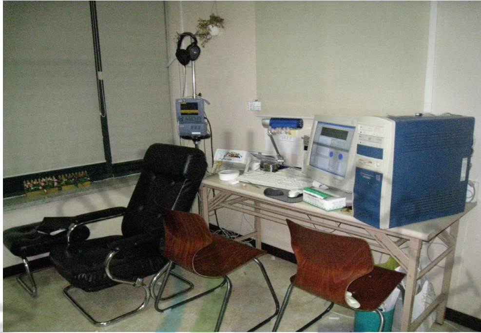
그림2.1-3 실험실 측정 도구 (의자, BIS 측정 장치, 헤드폰, 컴퓨터 등).
