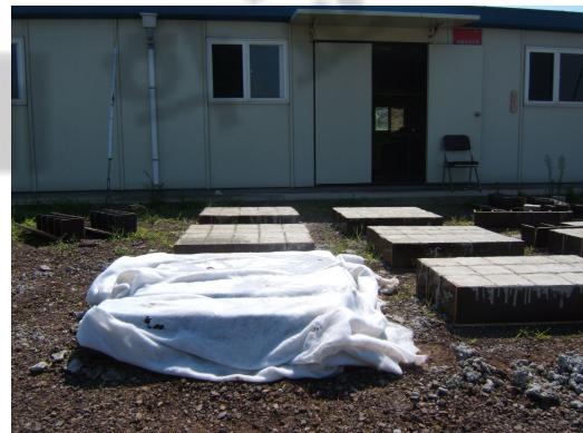
(4) 습윤 양생 조건 콘크리트 보양
