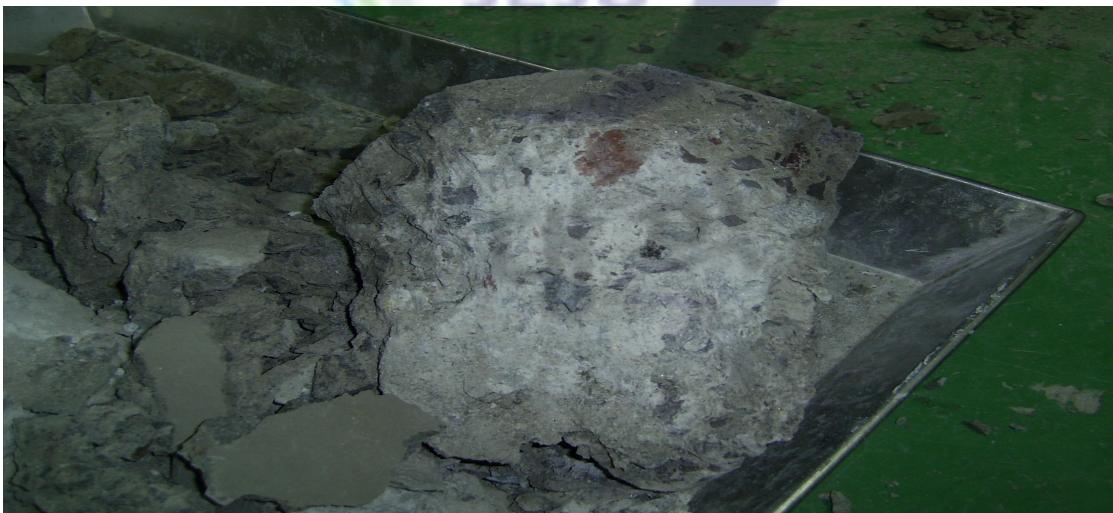
(3) 공시체 파괴 후 내부 포화 상태 확인
