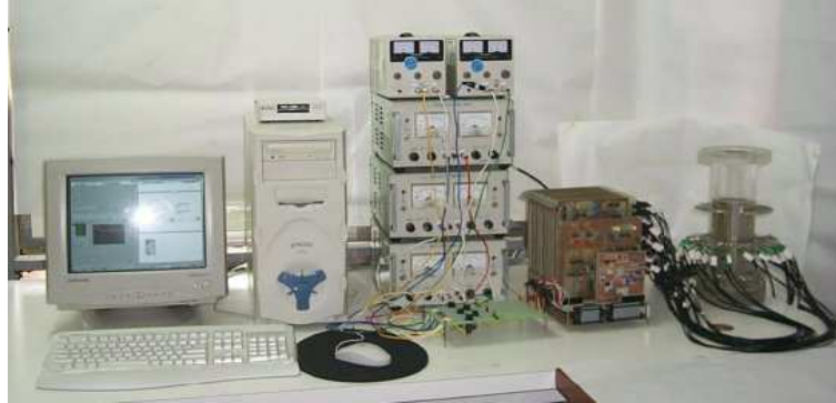
Fig. 4.3. EIT measurement system
